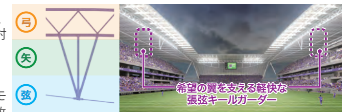
三本の矢・弦・弓をモチーフとした「張弦キールガーダー」
